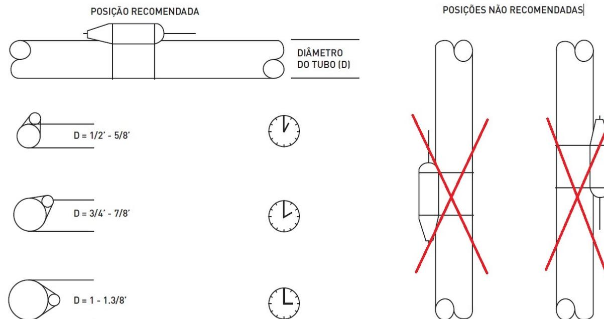
Figura 18 – Posição do bulbo da válvula de expansão
