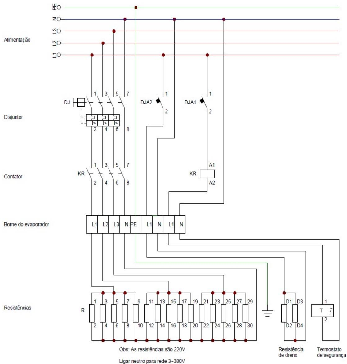
Figura 16 - Diagrama ligação resistências 3~380V – Modelos: FTBS\_388-488
