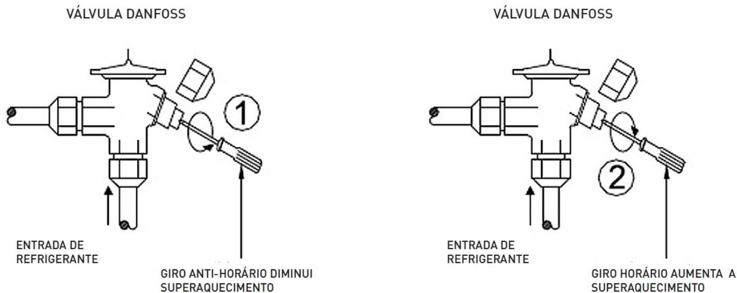
Figura 19 - Ajuste da válvula de expansão termostática
