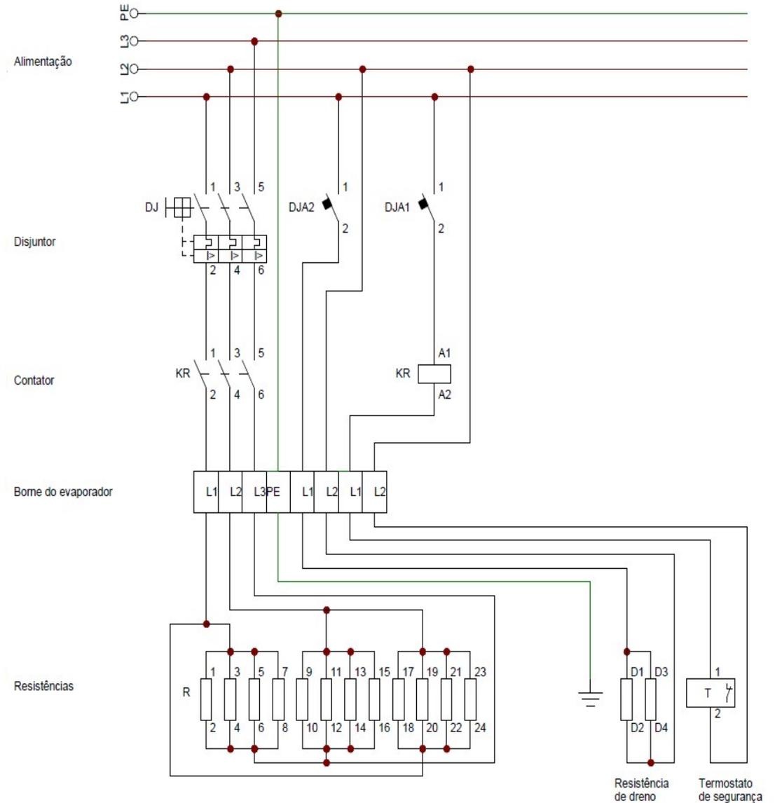
Figura 15 - Diagrama ligação resistências\_ 3~220V – FTBS\_368-468
