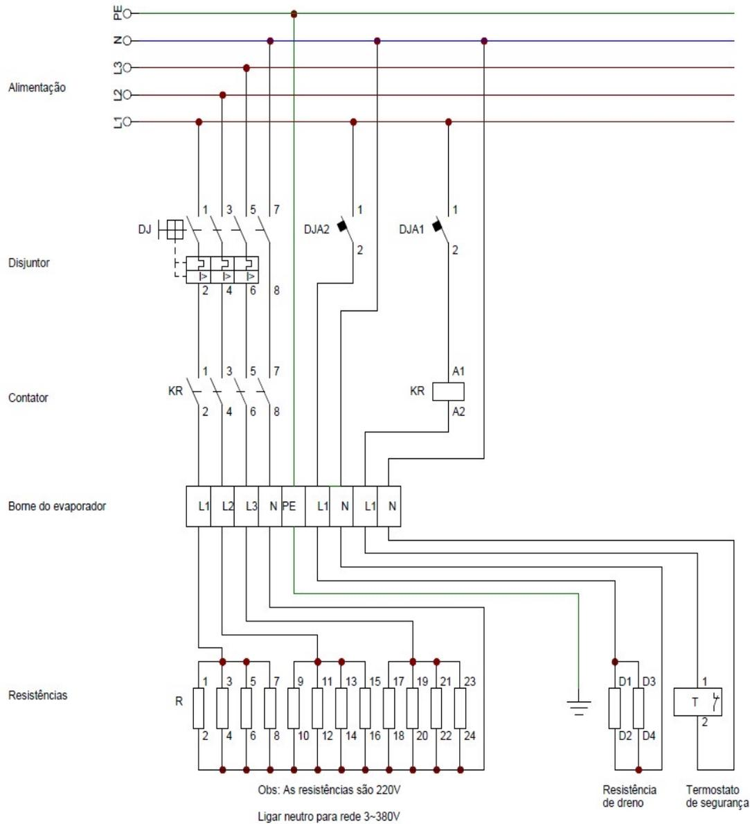
Figura 14 - Diagrama ligação resistências 3~380V – Modelos: FTBS\_368-46
