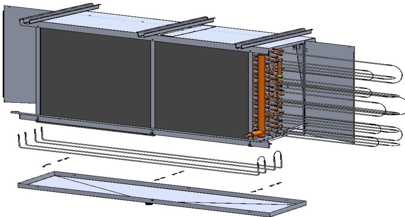
Figura 22 - Resistência de núcleo, retirada pela lateral
