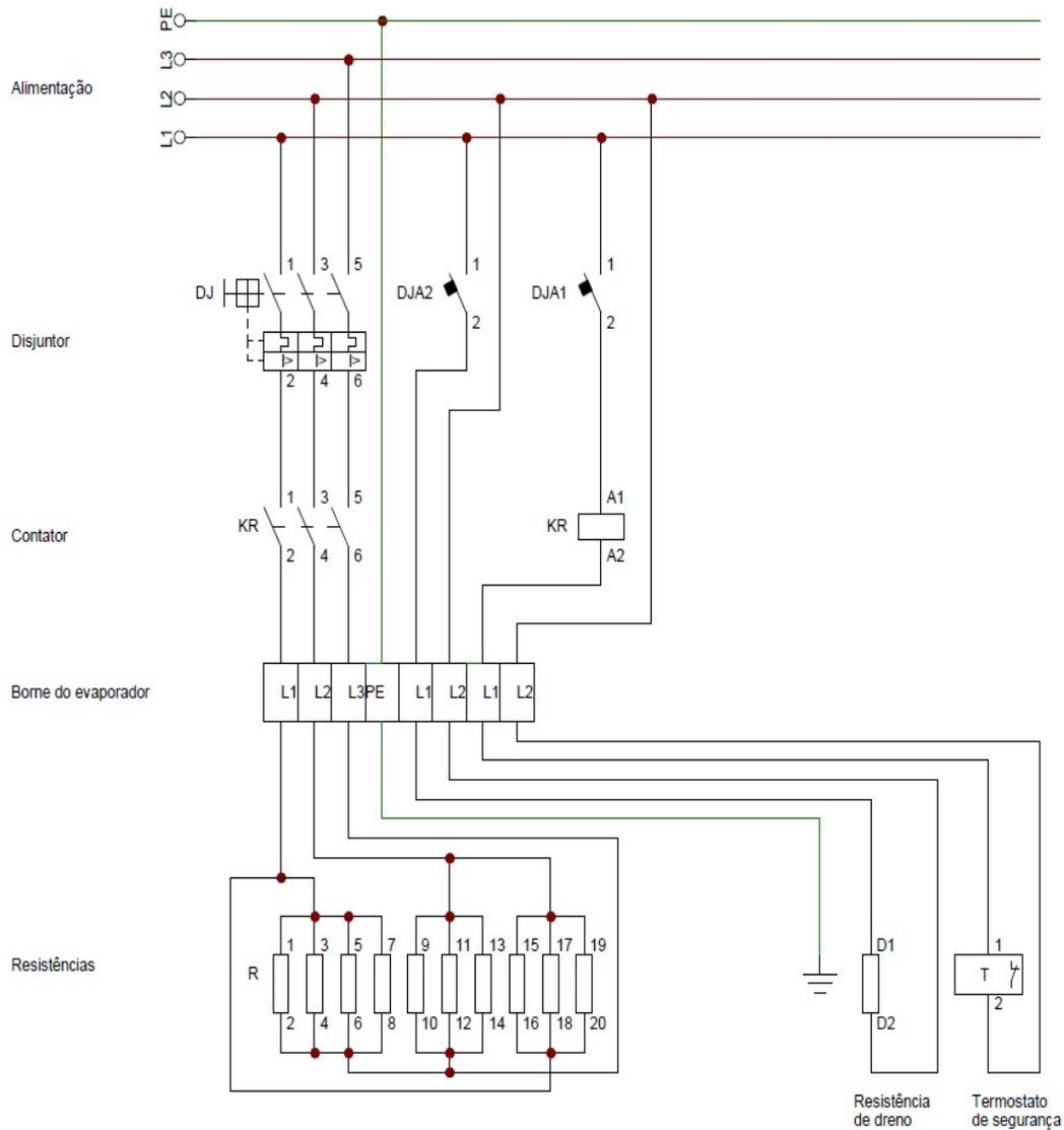
Figura 9 - Diagrama ligação resistências\_ 3-220V – Modelos: FTBS\_148-248
