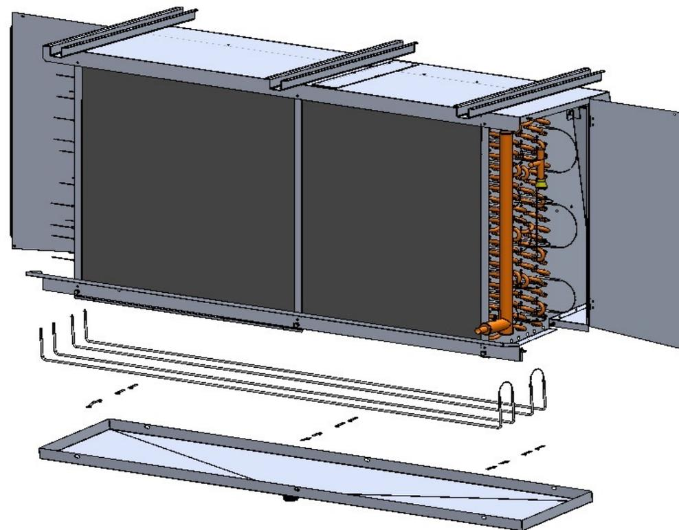
Figura 21 - Retirar a resistência de bandeja
