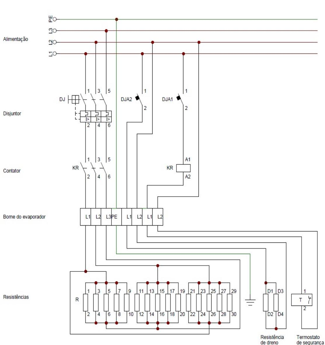
Figura 17 - Diagrama ligação resistências\_ 3~220V – FTBS\_388-488
