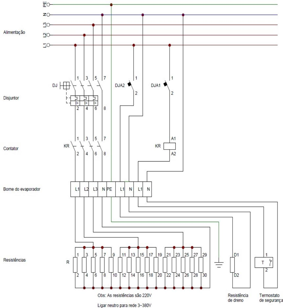
Figura 12 - Diagrama ligação resistências 3~380V – Modelos: FTBS\_188-288
