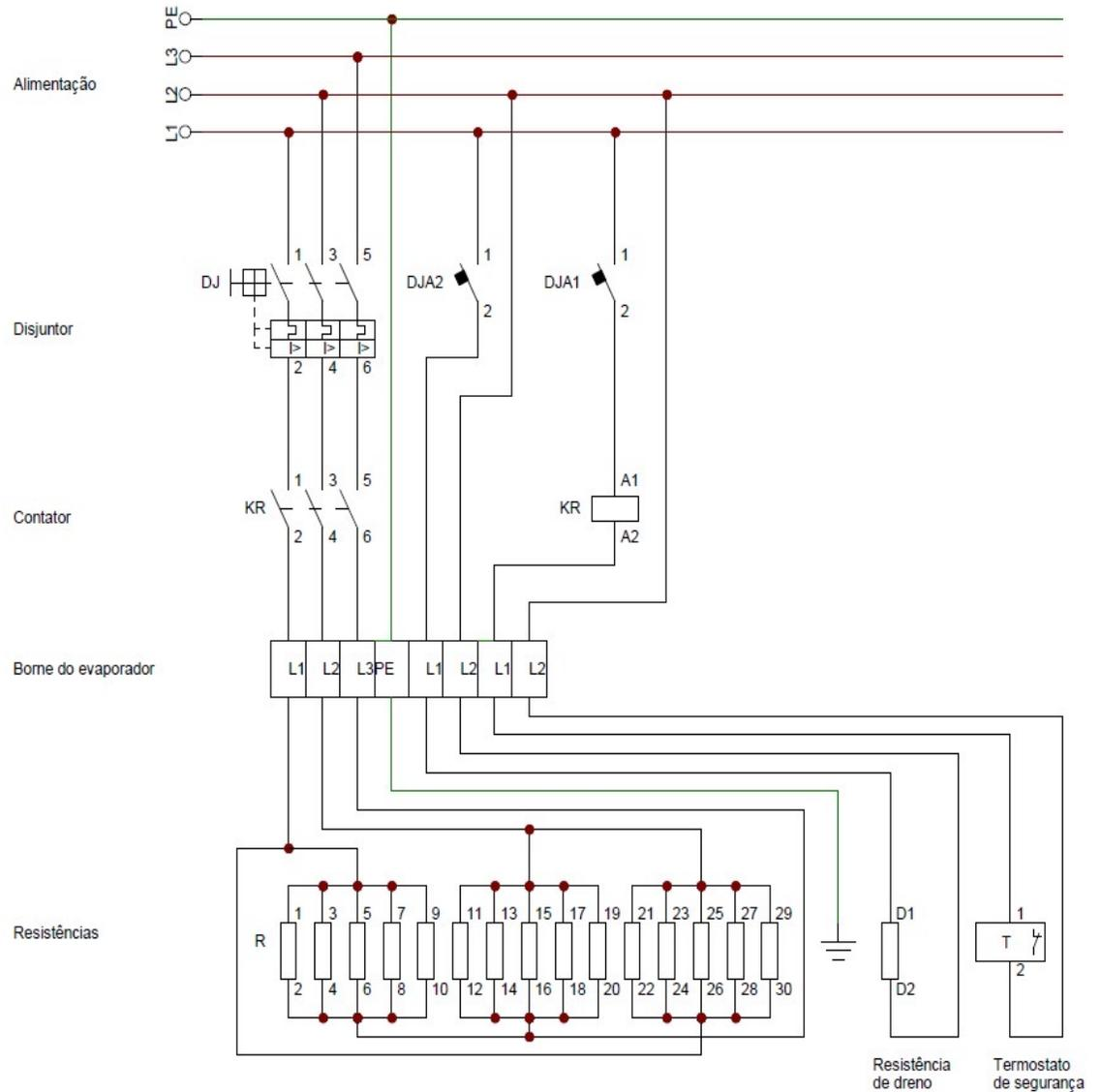
Figura 13 - Diagrama ligação resistências\_ 3~220V – Modelos: FTBS\_188-288
