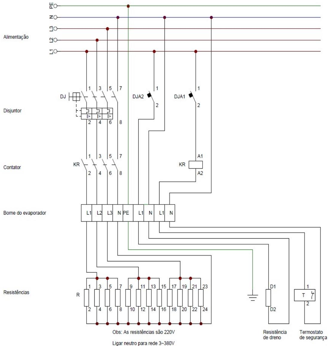
Figura 10 - Diagrama ligação resistências 3-380V – Modelos: FTBS\_168-268
