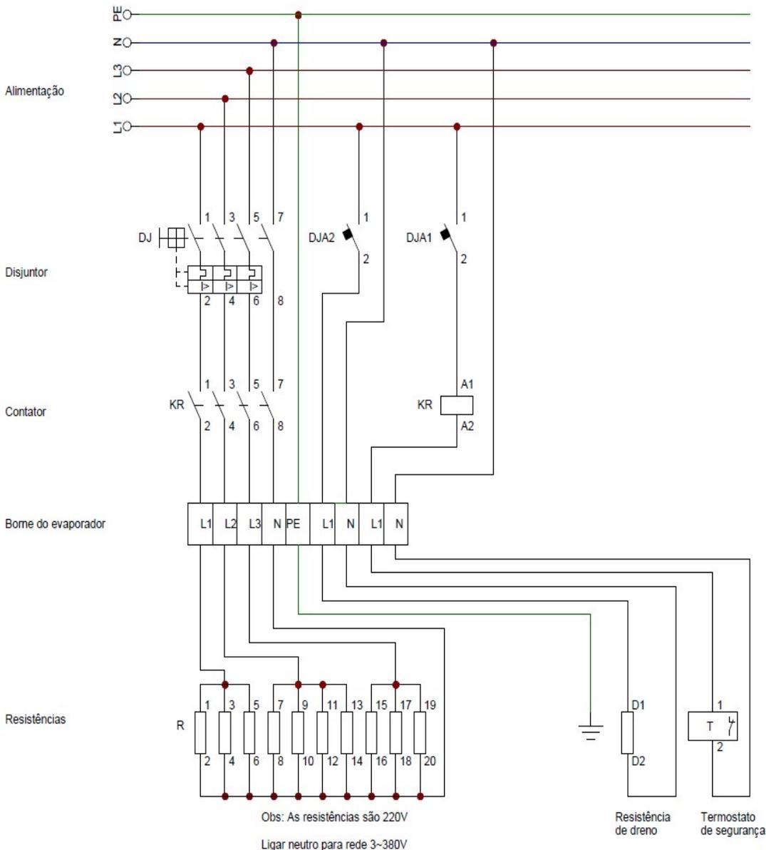
Figura 8 - Diagrama ligação resistências 3-380V – Modelos: FTBS\_148-248
