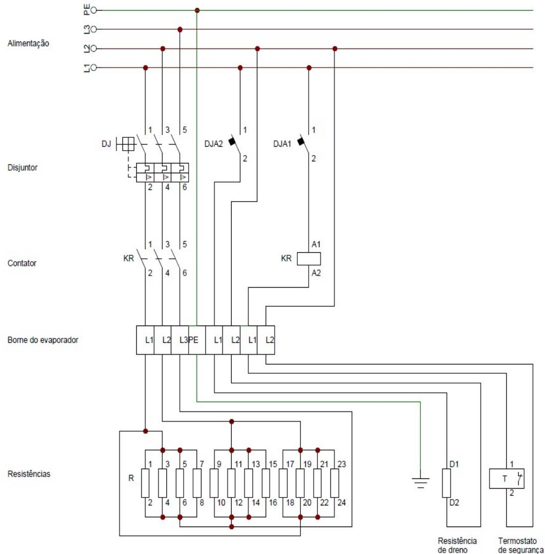
Figura 11 - Diagrama ligação resistências\_ 3-220V – Modelos: Modelos: FTBS\_168-
