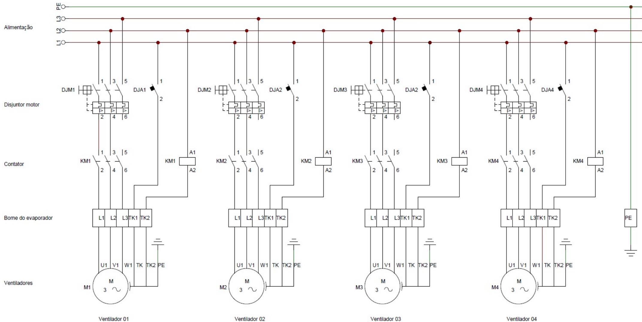
Figura 7 - Diagrama elétrico ventiladores linha FTBS 3~220/380V
